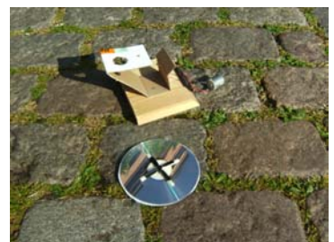
Pappstreifen auf Holzbrett geschraubt, CD von unten mit Propeller beklebt
