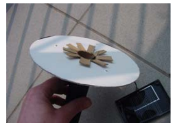
Grundplatte mit Kreis-ausschnitt, geschlitze Pappröhre wird auf Holzplatte geschraubt
