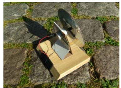
Motor von hinten durchstecken, Scheibe vorn aufstecken, Kontakte verbinden
