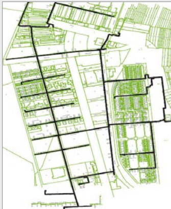
Das Heiznetz im Scharnhäuser Park
